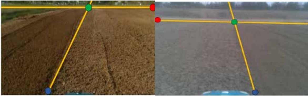
Рис. 1. Візуалізація трьох орієнтирів для меж обробітку ґрунту: Лінія, що з'єднує червона та зелена точки вказують напрямок руху, тоді як зелена та положення для розвороту трактора
