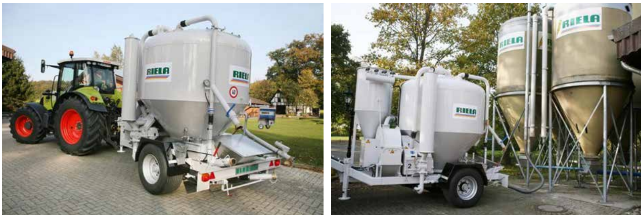
Рис. 1. Мобільна комбікормова установка RGM-3500 «RIELA».
