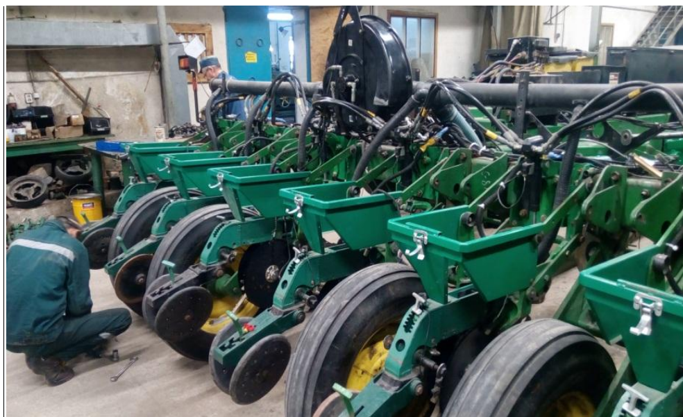
Рис. 2. Цех з ремонту та вдосконалення сівалок точного висіву JOHN DEER
