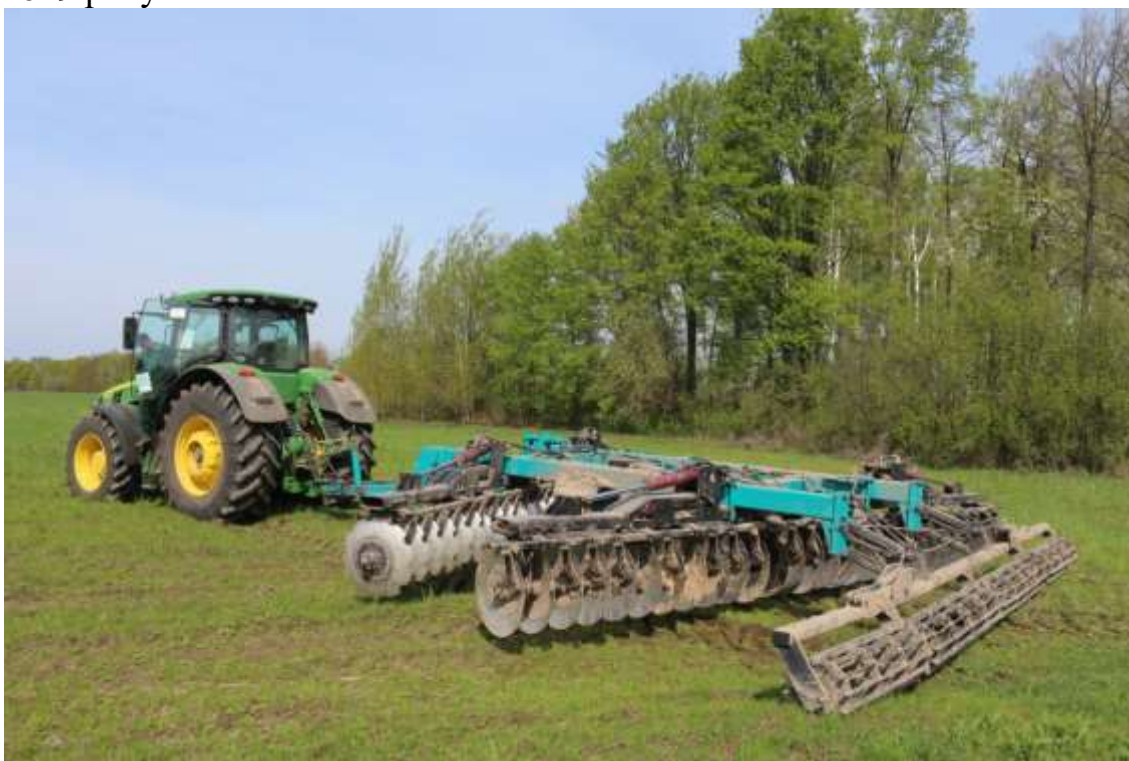
Рис. 1. Дискова борона БДВП-7,2 під час досліджень.
