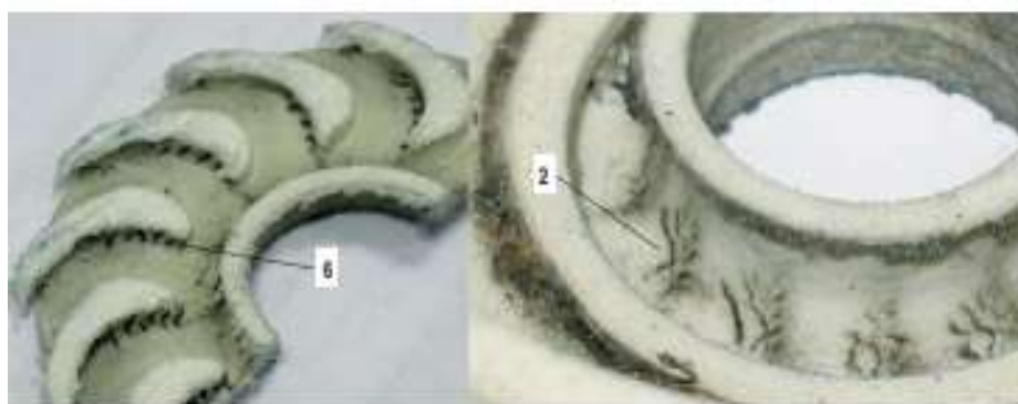
Рис.5. Внутрішні поверхні проточних каналів направляючого апарату
