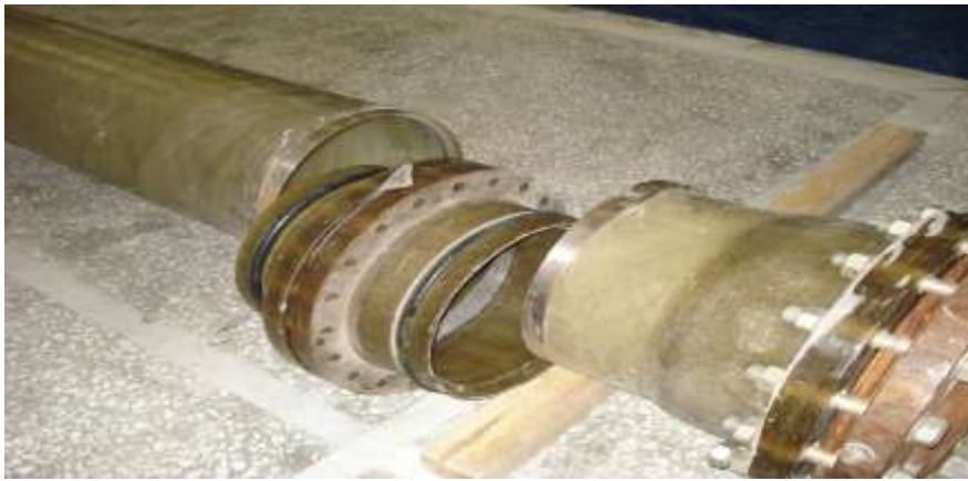
Рис. 1. Загальний вигляд гідроабразивного виду зносу заглибного насосу
