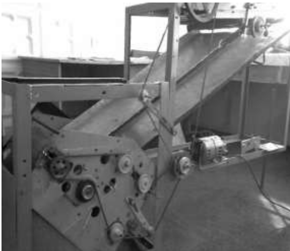
Рис. 1. Пристрій для обрушення насіння рицини: а – технологічна схема; б – загальний вигляд лабораторної установки [3]
