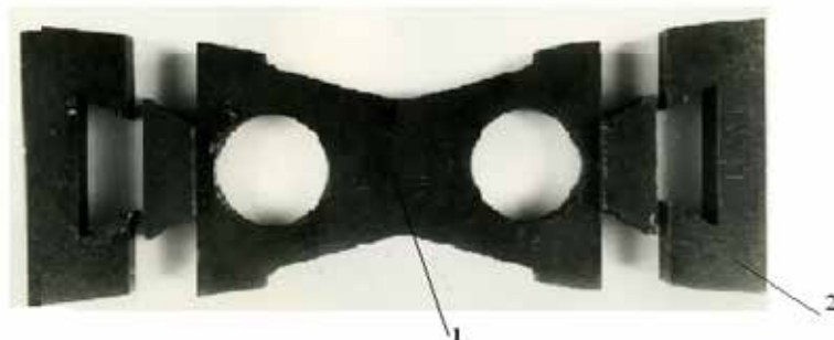
1 – основа молотка, сталь, Ст. 3;сталь 45; 2 – робоча (змінна) частина зі зносостійкого матеріалу
