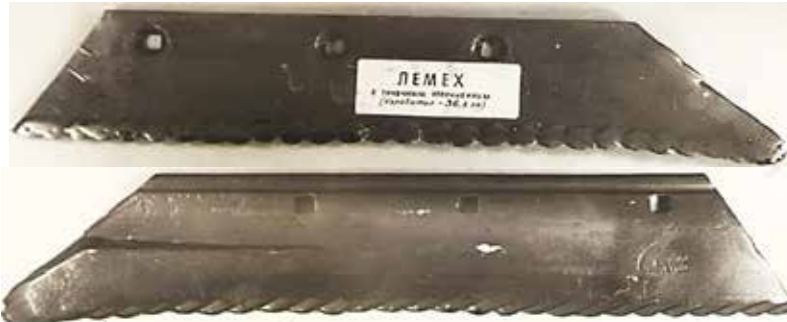
Рис. 2. Леміш з крапковим зміцненням, наробіток 36 га, утворення ефекту самозагострювання
