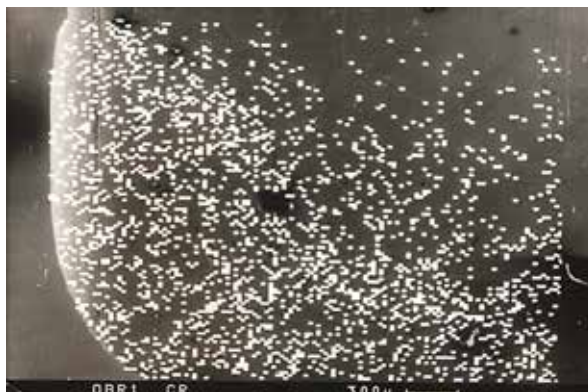
Рис. 1. Дифузійна зона композитного матеріалу; ( основа – матриця) на основі складного залізо-хромового карбіду
