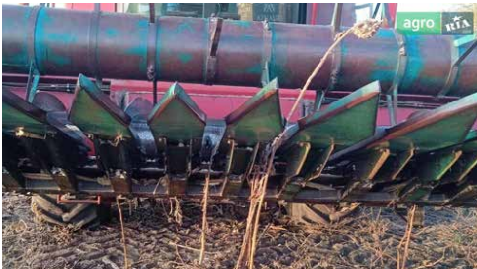
Рис. 4. Комбайн CASE 2388-Е з соняшниковою жаткою ПСП 1,5
