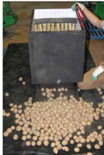
Рис. 3. Загальний вигляд контейнера, обладнаного еластичною перегородкою під час дослідження розкату бульб картоплі
