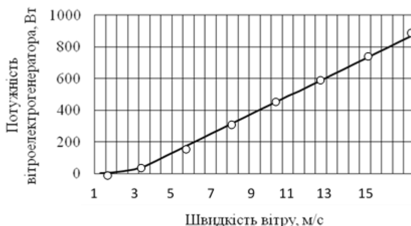
Рис. 3. Залежність потужності ВЕГ від швидкості вітру при струмі навантаження 25 А
