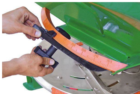
Рис. 2. Механізм для налаштування норми внесення добрив
