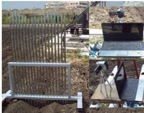
Рис. 5. Вимірювач профілю ґрунту: a – схема в аксонометрії; б – у процесі заміру.
