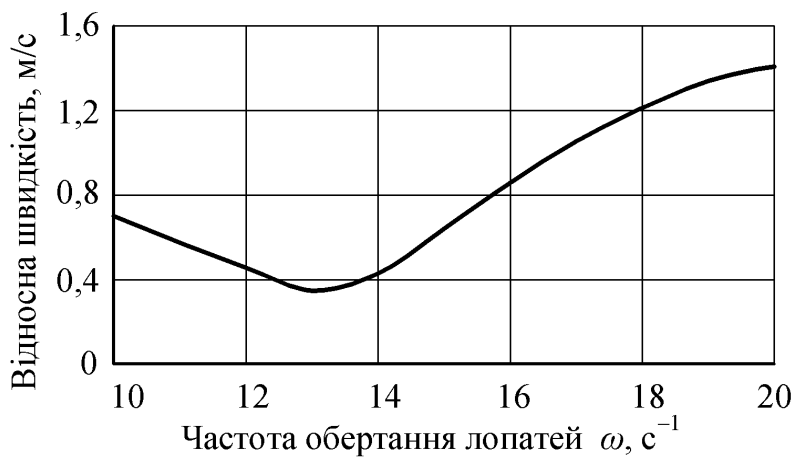
Рис.2. Залежність відносної швидкості \dot{x} частки M гички від кутової швидкості \omega обертання ( при l=0,1 \text{ m} and V_n = 35 \text{ m}\cdot\text{s}^{-1} )
