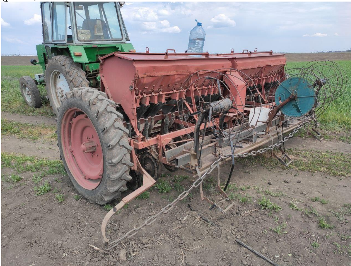
Рис. 1. Машино-тракторний агрегат для одночасної сівби та укладання крапельної трубки
