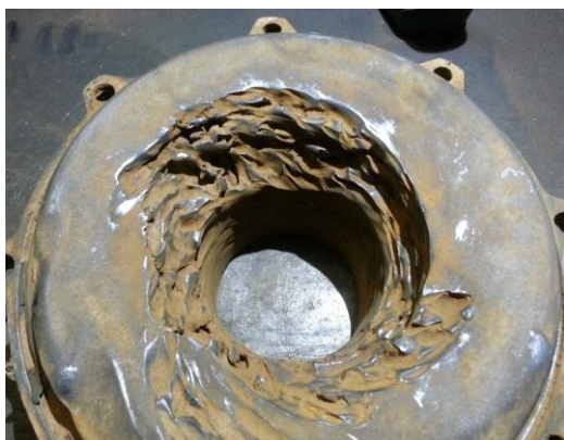
Рис. 1. Кришка відцентрового насоса в результаті водневого зносу
