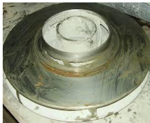
Рис. 2. Робоче колесо відцентрового насоса в результаті водневого зносу
