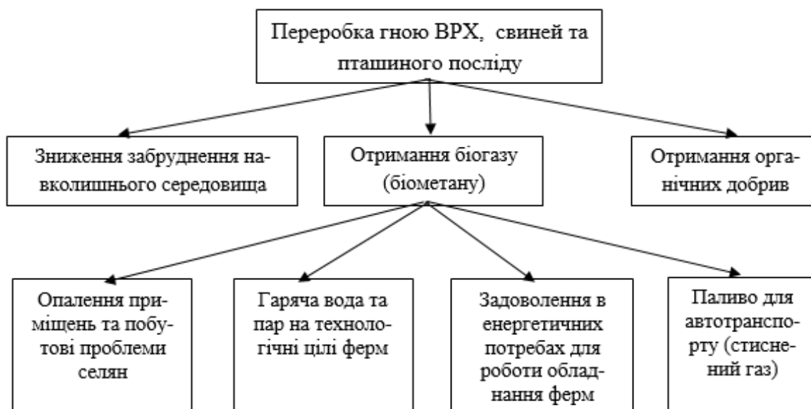
Рисунок 1 - Схема переробки відходів тваринництва
