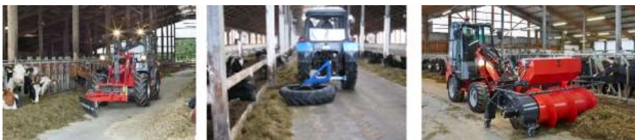
Рисунок 1 – Подталкивания корма тракторами с различным навесным оборудованием.
