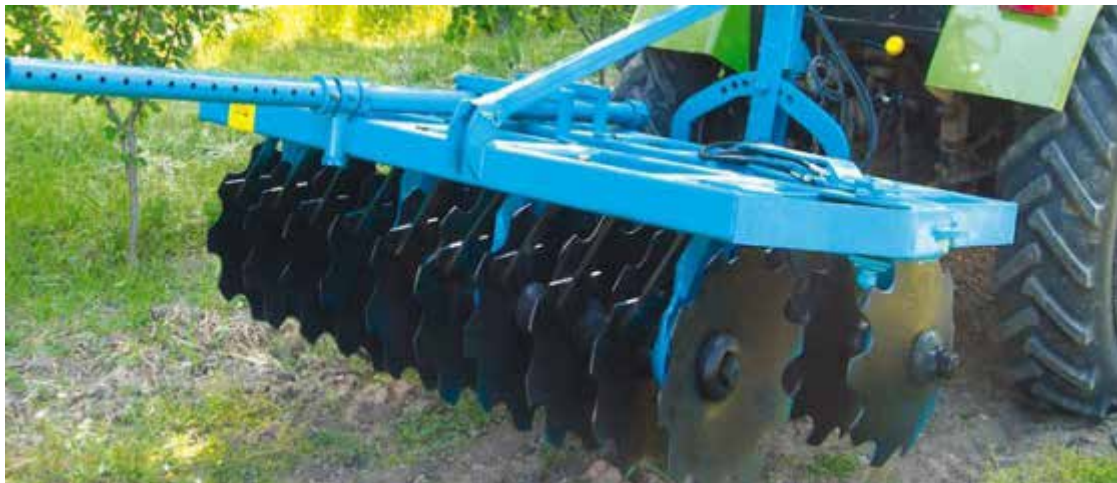
Рис. 1. Загальний вигляд борони БДН-2.5
