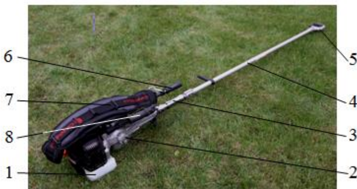
Рис. 1. Ручний віброударний струшувач волоських горіхів: 1 – двигун внутрішнього згоряння; 2 – збурювач коливань кривошипно-повзунного типу; 3 – ударний механізм; 4 – штанга; 5 – вилчастий захват; 6, 8 – рукоятки; 7 – механізм утримання і управління струшувачем
