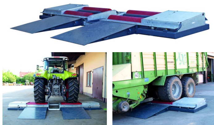
Рис. 2. Силовий роликівий гальмівний стелд для мобільних енергетичних засобів
