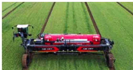
Рис. 2. Колійна система землеробства з використанням ширококоліїних (мостових) тракторів
