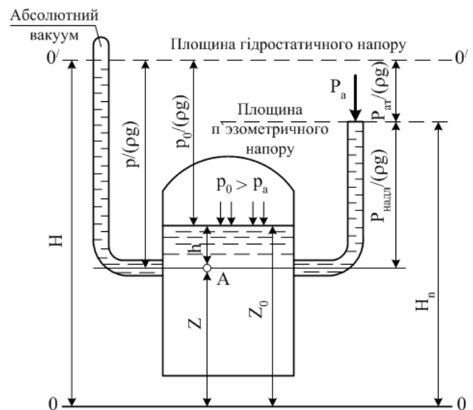
Рис. 6. Схема геометричного зображення (інтерпретація) основного рівняння гідростатики.
