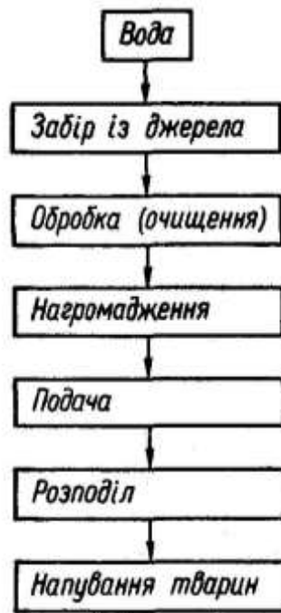
Рисунок 5.2 – Схема технологічного процесу водопостачання ферми і напування тварин
