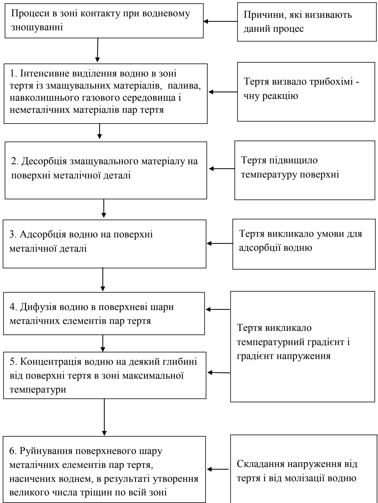
Рисунок 8.1 – Схема етапів водневого зношення
