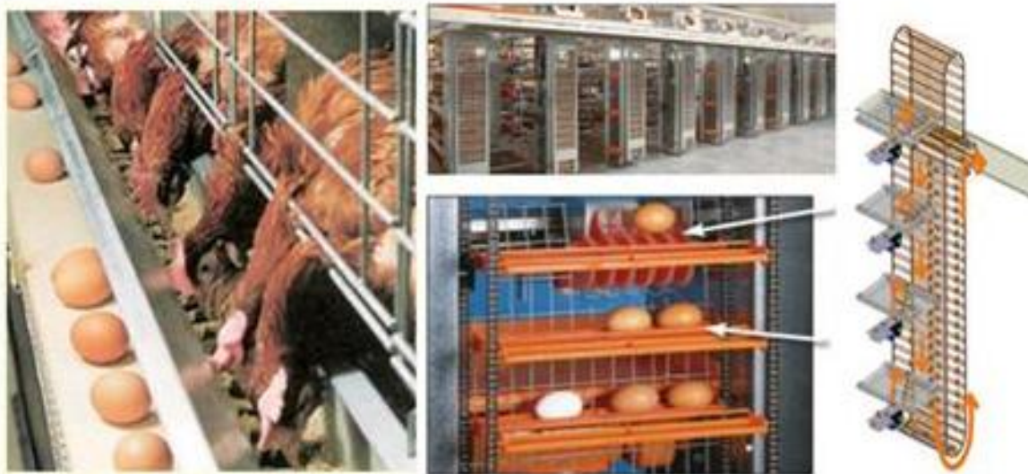
Рис. 1.22. Транспортери повздовжній стрічкового типу та поперечний елеватор для збирання яєць з кліткової батареї
