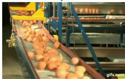
Рис. 1.22. Транспортери повздовжній стрічкового типу та поперечний елеватор для збирання яєць з кліткової батареї
