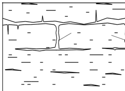
Рис.8. Розповсюдження поверхневих тріщин утоми по глибині зразка сталі.
