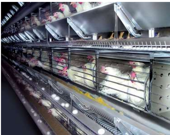
Рисунок 2 – Загальний вид кліткової батареї типу ТБК
