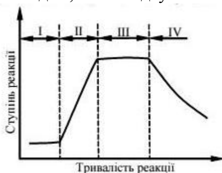
Рис. 8 Схема протікання механотермічної реакції
