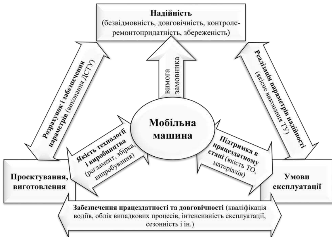
Рис. 1. Схема формування надійності мобільних машин
