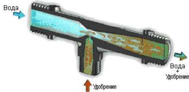
Рис. 2. Схема работы инжектора Вентури.
