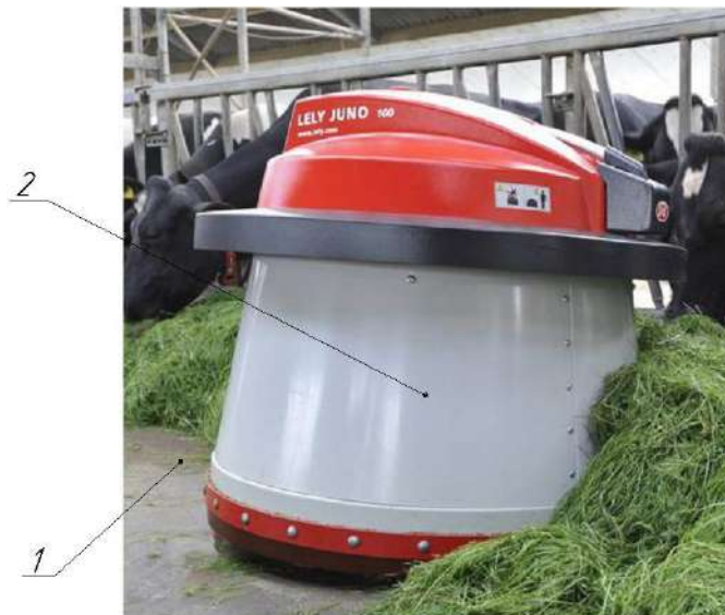
1 – кормовой стол; 2 – роботизированный пододвигатель
