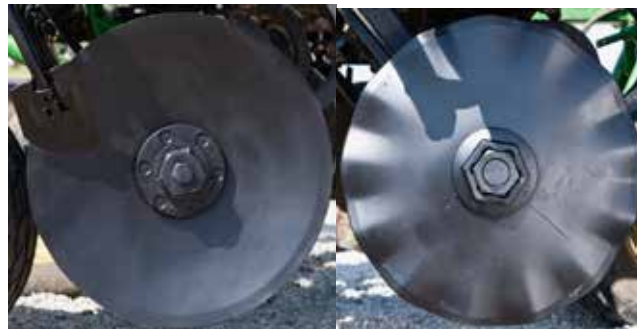
Рис. 3. Конфігурація лез дисків різних секцій машини
