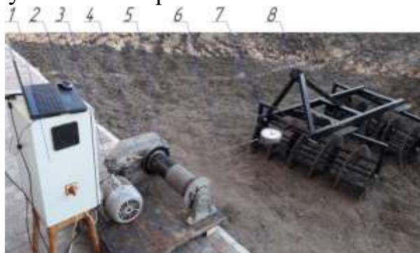
Рис. 3. Загальний вигляд експериментальної установки та обладнання для визначення тягового опору борони з гвинтовими робочими органами змінювали частоту напруги, яка подавалась на двигун.
