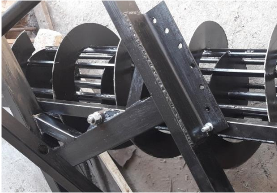
Рис. 1. Загальний вигляд гвинтового робочого органу
