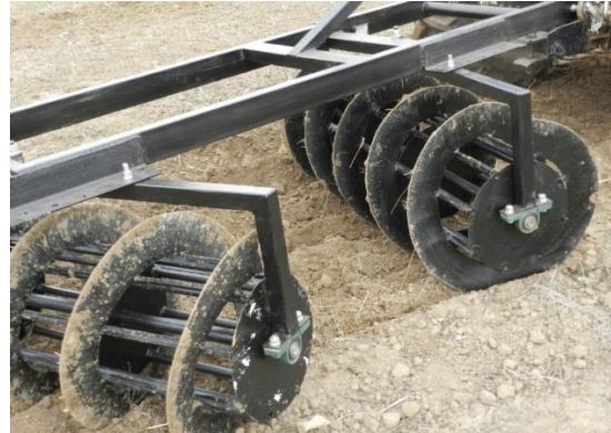
Рис. 2. Загальний вигляд експериментального зразка борони з гвинтовими робочими органами
