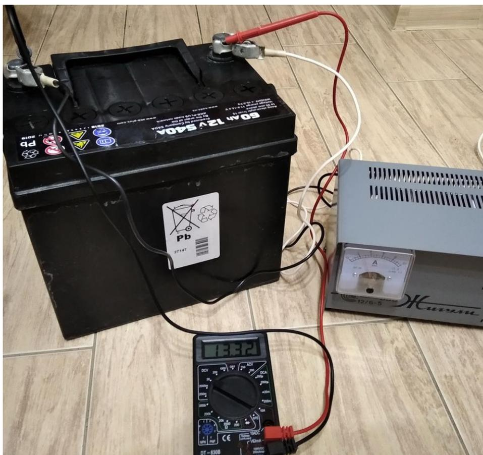
**Рис. 4. Заряджання акумуляторної батареї SADA OPTIMA із використанням ВЗУ «Жигулі»**
