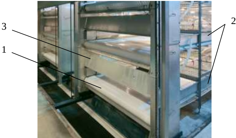
1 – стрічковий транспортер, 2 – короб (пояс) для посліду, 3 - скребок
