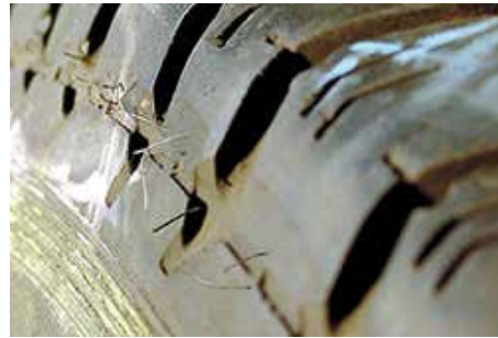
Рис. 4. Розрив ниток в каркасі
