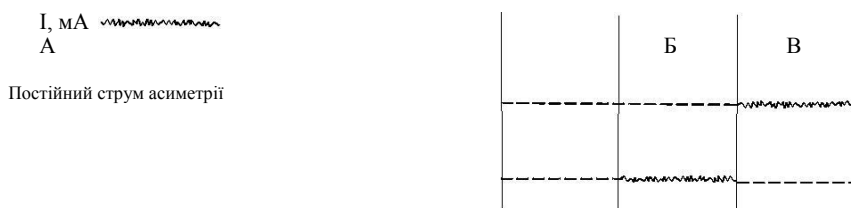
Рис. 15.3. Осцилограма струму, відповідна трьом різним режимам тертя
