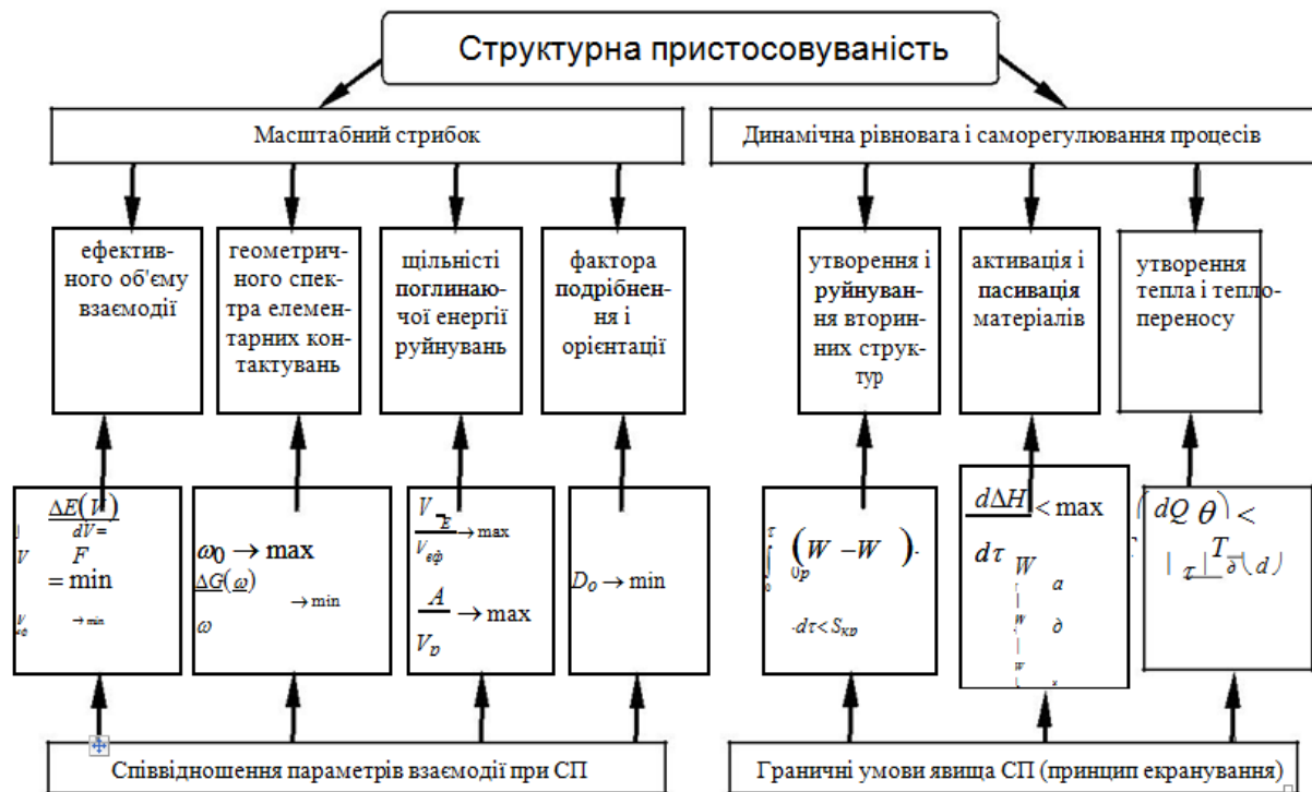
Рис. 3.6. Фізична модель структурної пристосовуваності матеріалів при терті
