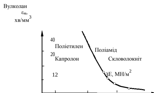
Рис. 4.6. Залежність зносостійкості полімерних матеріалів від модуля пружності
