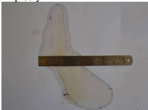
Рис. 1. Фрагмент вимірювання розміру плями в горизонтальному напрямку лінійкою (ПММ – свіже моторне масло)
