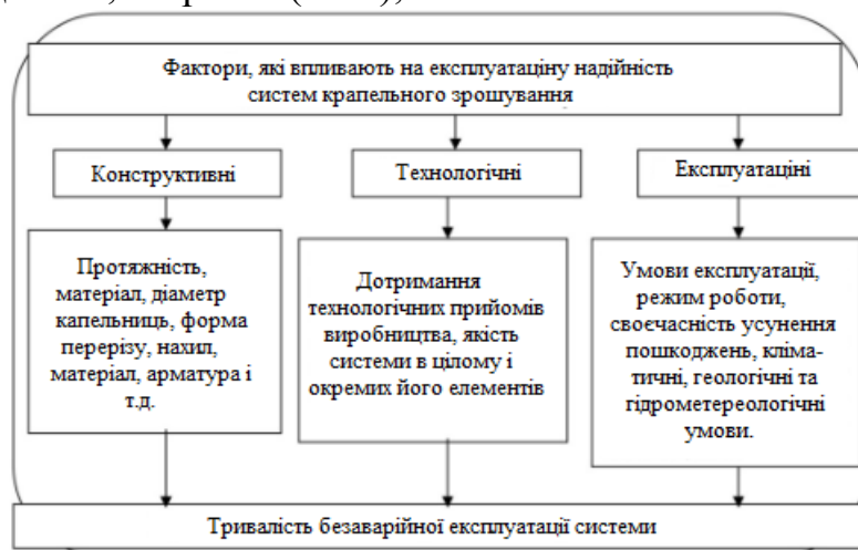
Рис. 2. Структурна схема основних факторів, що впливають на експлуатаційну надійність системи крапельного зрошення
