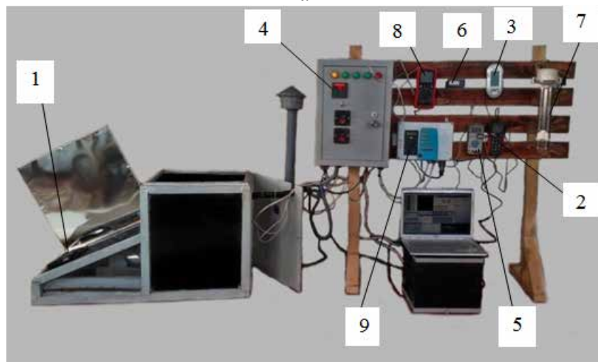
Рис. 1. Конструктивно-технологічна схема геліосушарки з тепловим акумулятором (а) та плоский дзеркальний концентратор і загальний вигляд дослідної установки (б): 1 – вхідний канал; 2 – волого осушувач теплоносія; 3 – повітропровід; 4 – повітряний колектор; 5 – тепло-акумуляуючий матеріал (ТАМ); 6 – сушильна камера; 7 – витяжний канал; 8 – решета; 9 – плоский дзеркальний концентратор; 10 – заслінка
