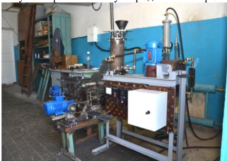
Макет установки для переробки рицини
