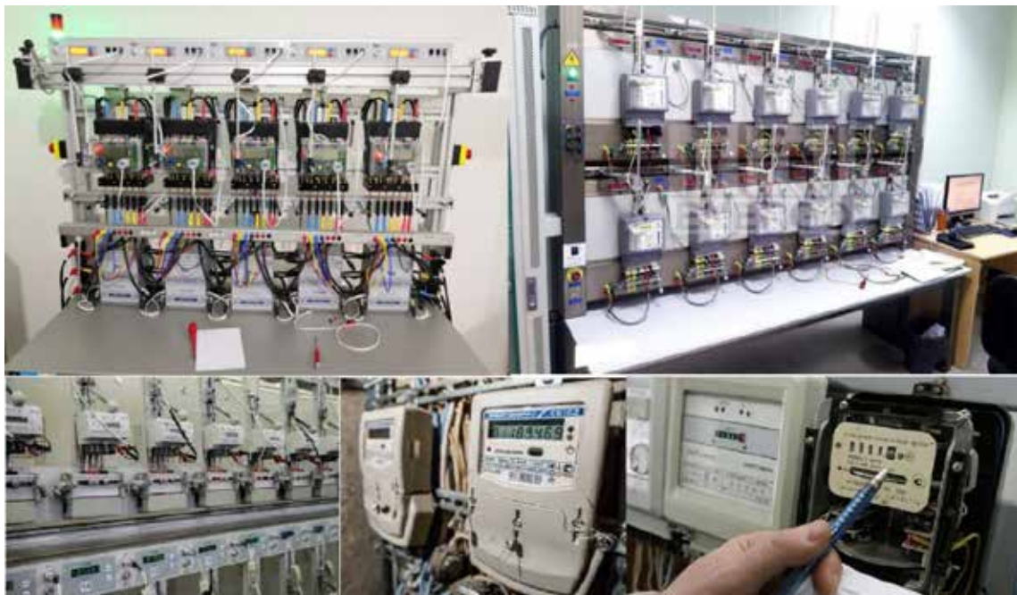
Рис. 1. Випробування лічильників електричної енергії на стенді
