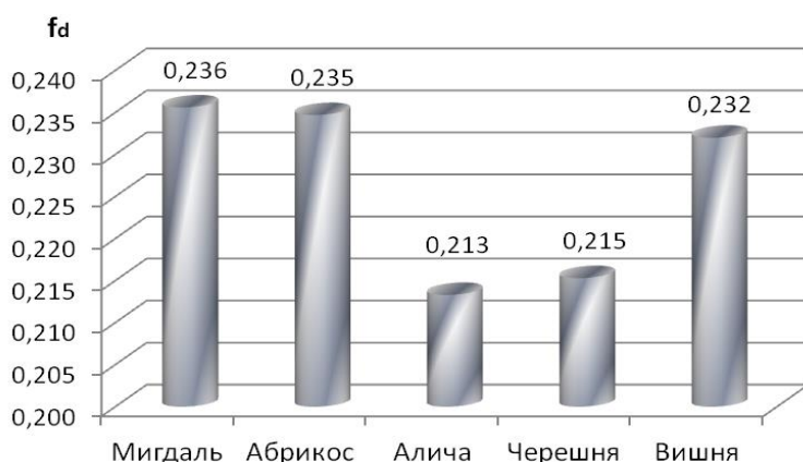
Рисунок 1 – Значення динамічних коефіцієнтів зовнішнього тертя насіння кісточкових культур по перфорованій поверхні
