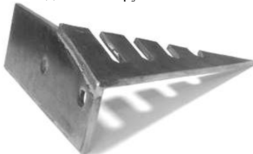
Рисунок 1 – Плоскоріжучий робочий орган з прорізами розташовані в області робочого органу
