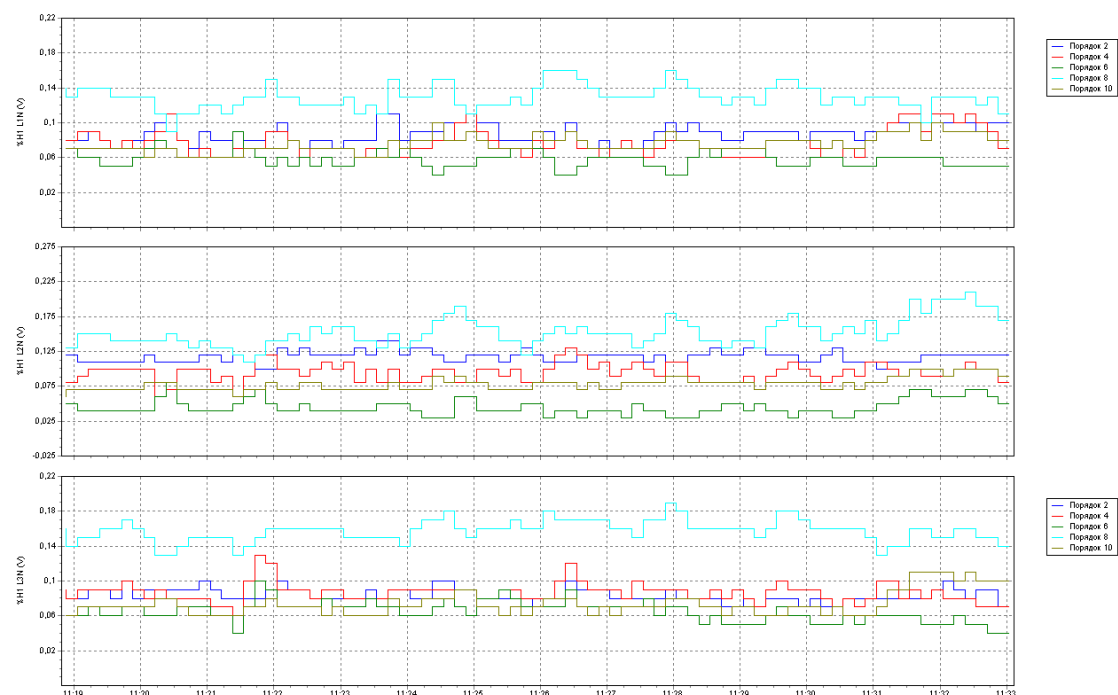
Рис. 1. График изменения уровня четных высших гармонических составляющих напряжения по фазам А, В, С, соответственно на ТП 648 «н.п. Дещенка ВРУ молочно-товарного комплекса (ввод 1)»
