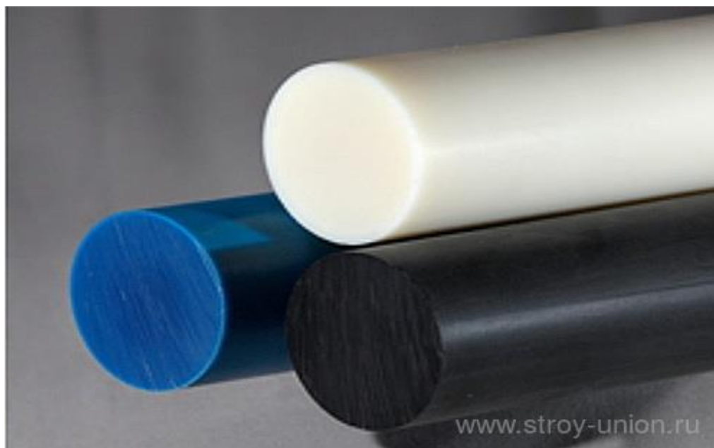
Рис. 5. Триботехнічні матеріали на основі полімерів
