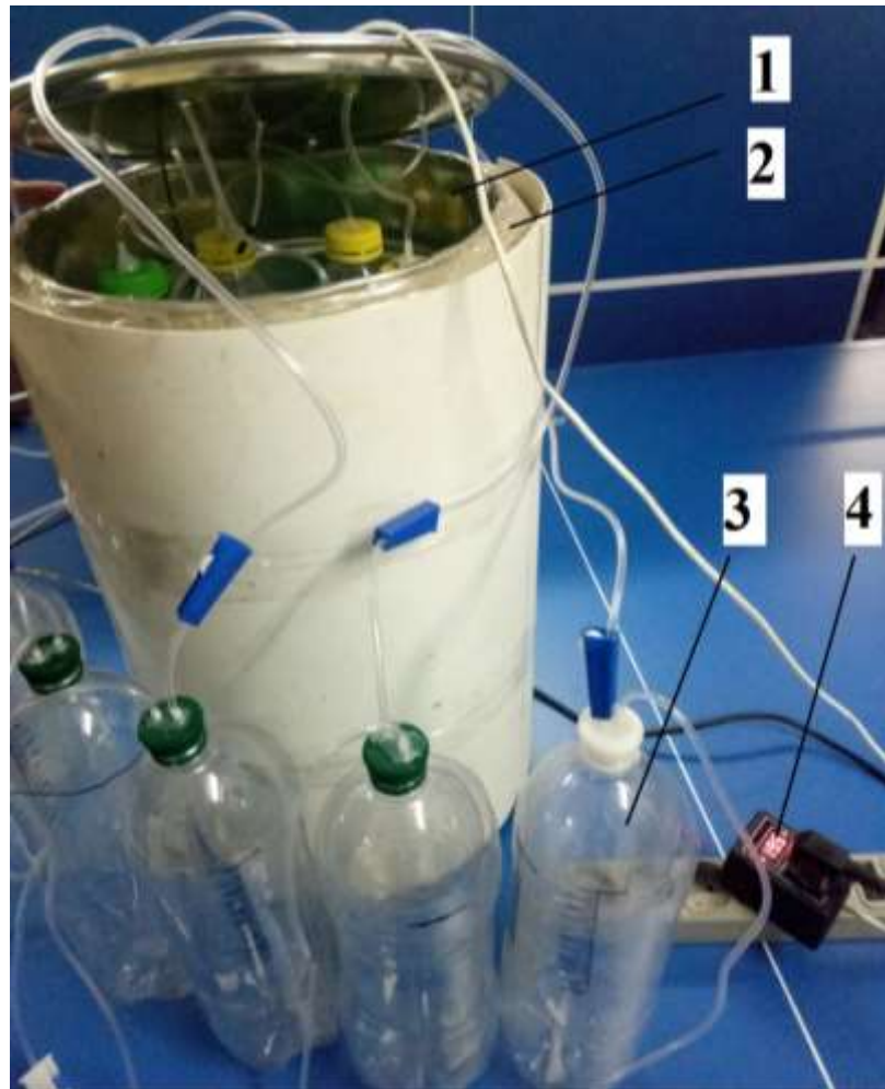
1 – реактор, 2 – нагрівальний пристрій, 3 – газгольдер, 4 – терморегулятор МТР-2
