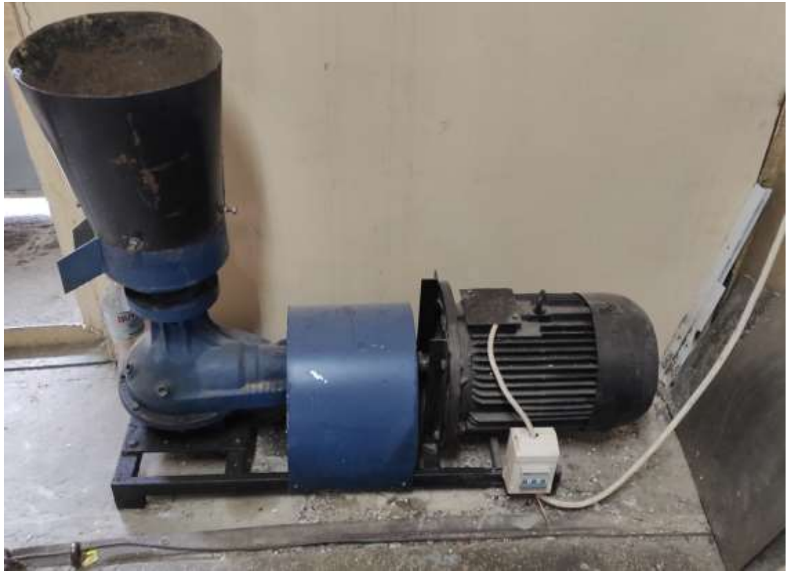
Рис. 2.4. Гранулятор зерновмісних матеріалів
