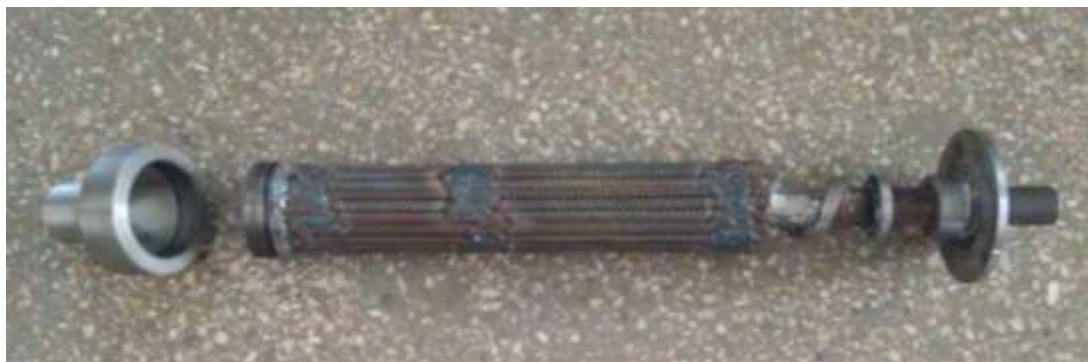
Рис. 2.3. Екструдер зерновмісних матеріалів з холодним нагрівом
