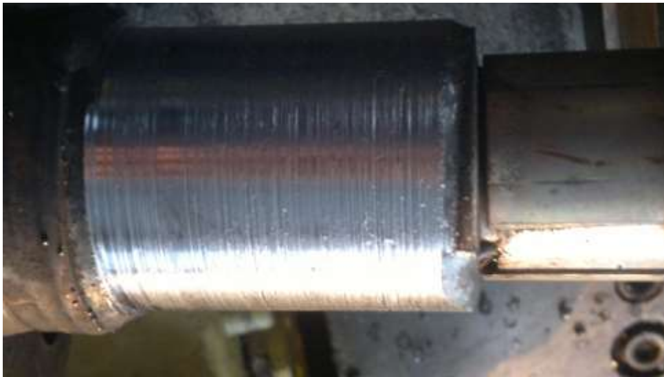
Рисунок 1.6 - Вигляд валу після чорнового точення (різьба закрита захисною стрічкою)
