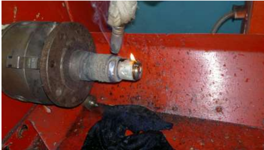
Рисунок 1.4 – Процес наплавлення на установці УД-209
